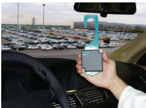
Abb. 6: H+P CLS PLUS rf basiert auf einem modernen RFID Ortungsverfahren, das eine Positionsbestimmung der Fahrzeuge in Echtzeit ermöglicht!
